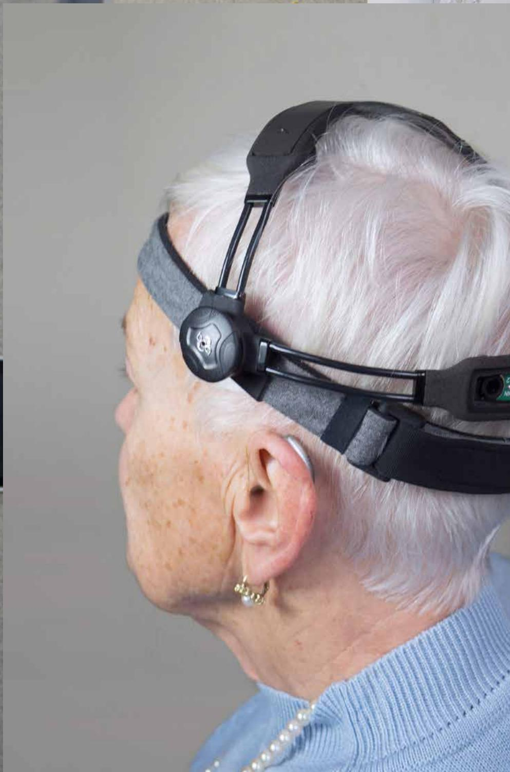
**Steuerung am Kopf** – Sensoren erfassen Gedanken und wandeln sie in Befehle um
